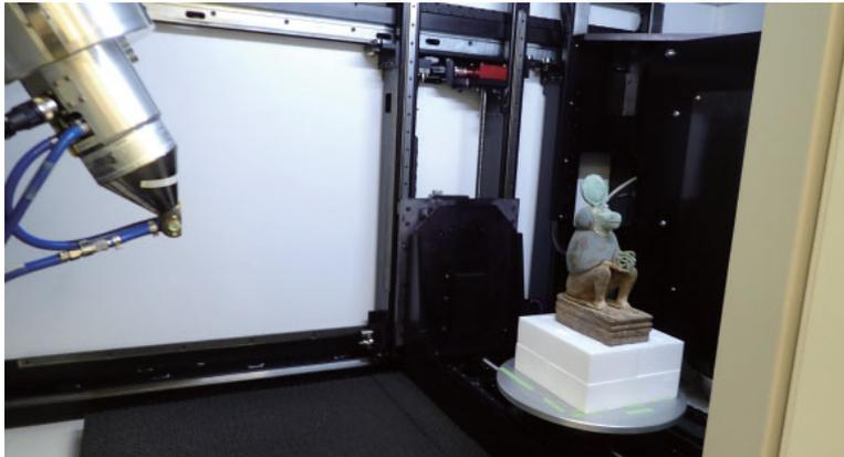
図5 X線CTスキャン装置のチャンバー内のセッティング。左側はX線発生装置。右側の黒い板状のものが検出器
